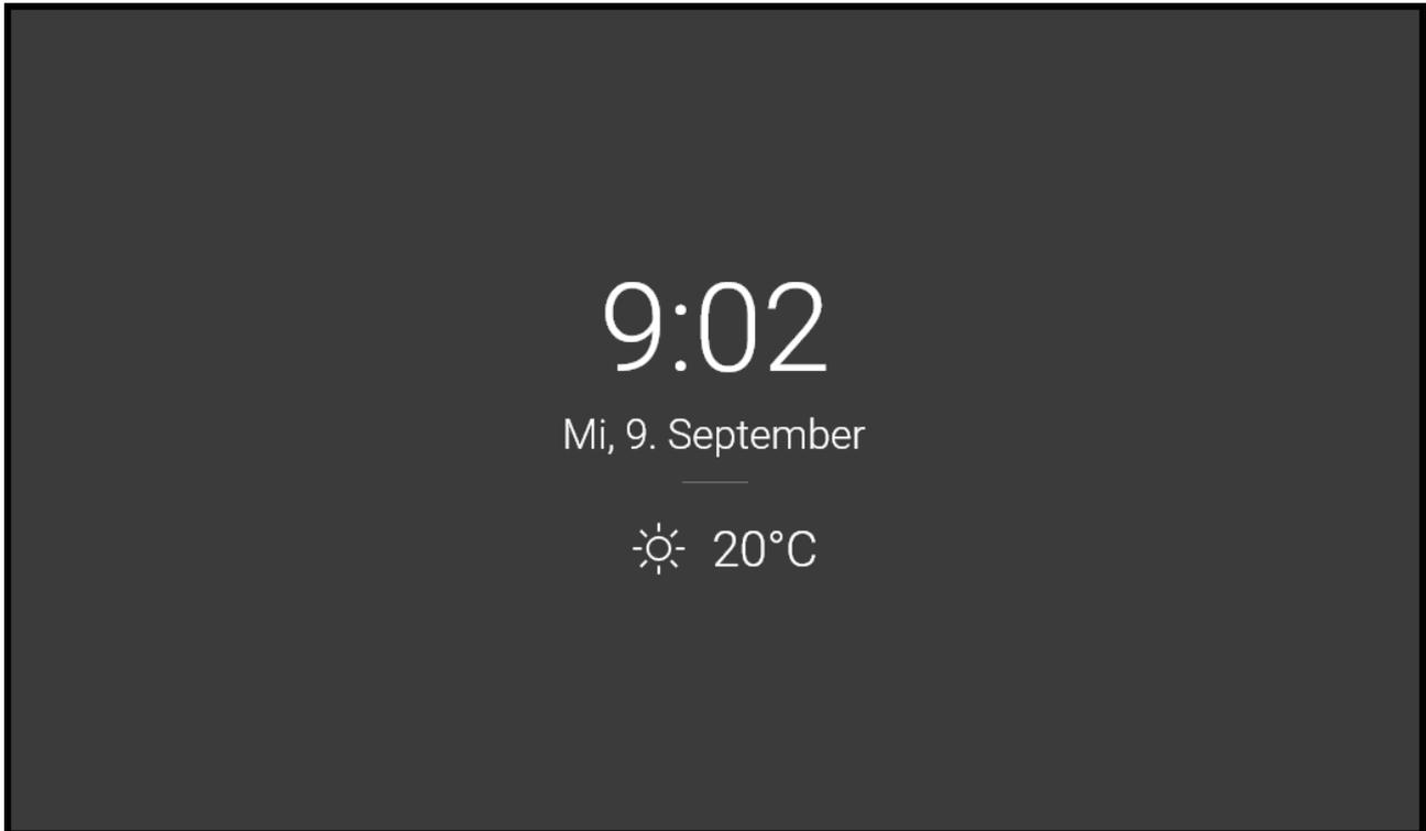
Das Gerät wechselt automatisch in den Ruhemodus, wenn es inaktiv ist (nach Auswahl einer Zeitverzögerung von 15 s - 10 min). Die Konfiguration des Geräts ermöglicht die Anzeige von Datum und Uhrzeit, aktuellen Wetterinformationen und Türkontakt-Statusmeldungen während des Ruhemodus.
